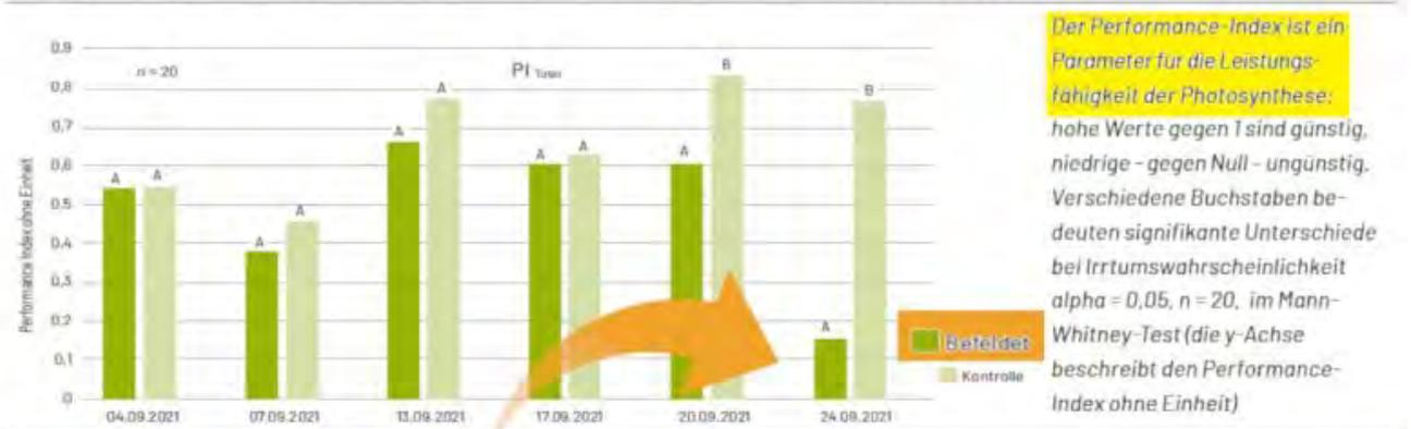
Der Performance-Index ist ein Parameter für die Leistungsfähigkeit der Photosynthese:
